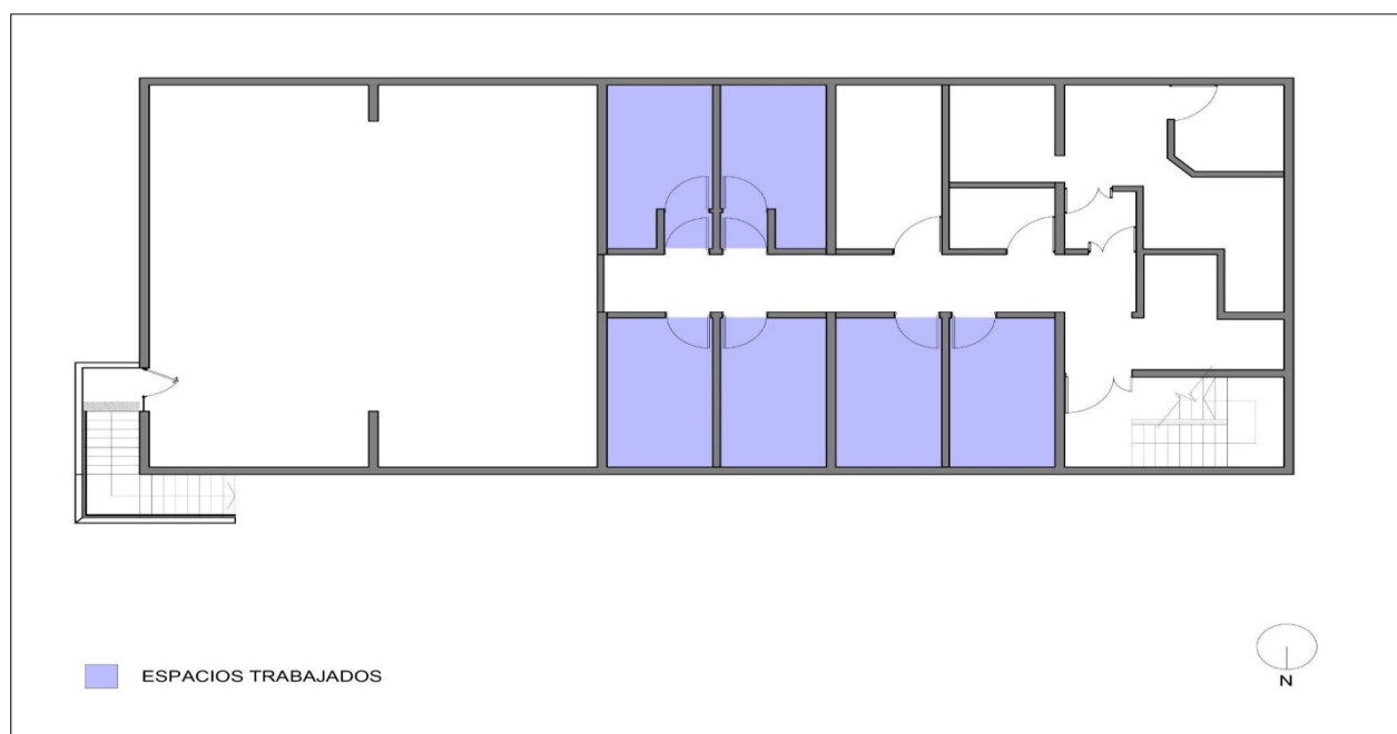
Planta Esquemática de Subterráneo Bioterio Milenio, salas intervenidas con revestimiento vinílico en muros
